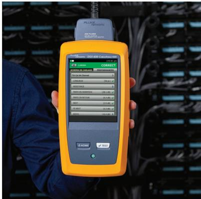
Le DSX-600 permet d'effectuer une certification des liaisons cuivre de Cat 6<sub>A</sub> et de classe E<sub>A</sub> avec une durée de test de 10 secondes et une interface utilisateur avancée. Gérez les testeurs et projets issus de n'importe quel dispositif intelligent via le Wi-Fi avec LinkWare™ Live. Intègre la fiabilité légendaire de Fluke Networks assurée par une assistance à l'échelle mondiale.
