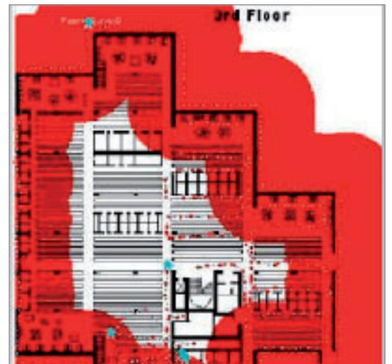
Figure 7 : Débordement des radiofréquences à l'extérieur des locaux de l'entreprise.
