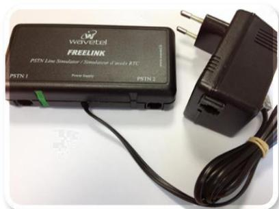
Le Freelink permet de simuler deux lignes téléphoniques. Il est équipé de douilles pour la connexion de n'importe quels appareils à deux appels commutés (modems ou téléphones). Il est particulièrement adapté pour les démonstrations hardware et software, les formations, le développement, l'installation et les travaux de maintenance.
