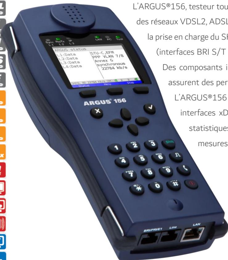
L'ARGUS®156, testeur tout-en-un avec écran couleur offre la prise en charge des réseaux VDSL2, ADSL (Annexes A, B, et M) et SHDSL (2,4 et 8 fils avec la prise en charge du SHDSL.bis EFM/ESHDSL) si besoin, Ethernet, RNIS (interfaces BRI S/T et U - 2B1Q ou 4B3T) et même RTC.
