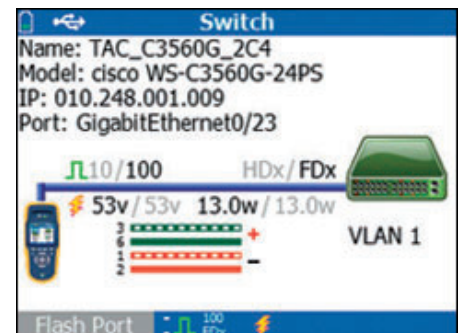
Liaison 100 Mbits/s sur cuivre avec PoE sur le port 23
