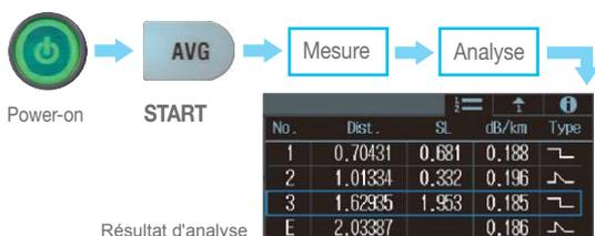
Les données mesurées peuvent être enregistrées automatiquement si on le souhaite.
