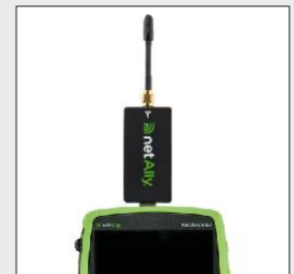
Analyseur de spectre portable NXT-1000 en option pour 2,4/5 GHz.
