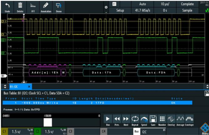
En mode historique, les acquisitions antérieures sont disponibles pour une analyse plus poussée, avec la profondeur mémoire segmentée maximale de 400 Méchantillons. Les fonctions telles que les tests de masques, la mesure rapide QuickMeas et FFT peuvent être utilisées pour une analyse approfondie.
