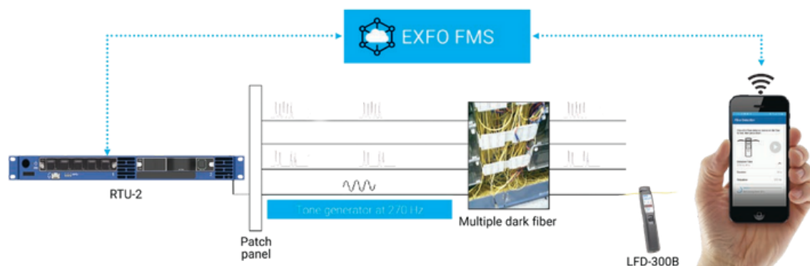
Figure 3. Mode source/tonalité pour l'identification des fibres.
